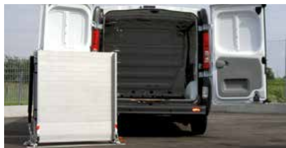
Trittfläche aus rutschfestem, eloxiertem Aluminium
